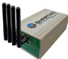
Базовая станция представляет собой сетевой радио-шлюз (GW), предназначенный для построения LPWAN-сетей на основе протокола LoRaWAN для приема-передачи данных между оконечными устройствами и сервером LoRaWAN-сети.
